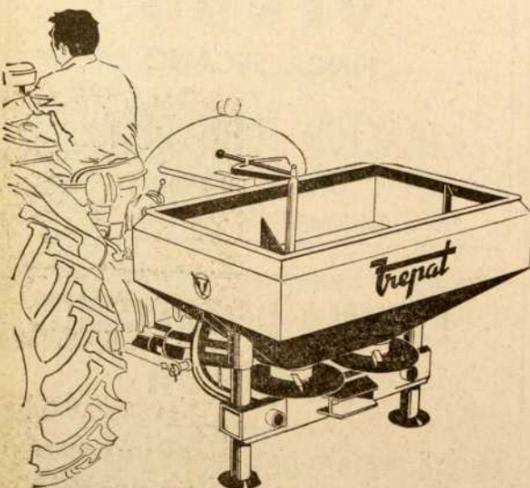
Ancho de esparcido: hasta 16 metros. Dos discos de distribución precisa, uniforme y simétrica en toda la superficie. Dosificación regulable desde el asiento. Capacidad tolva vibrante, 425 kilos.
