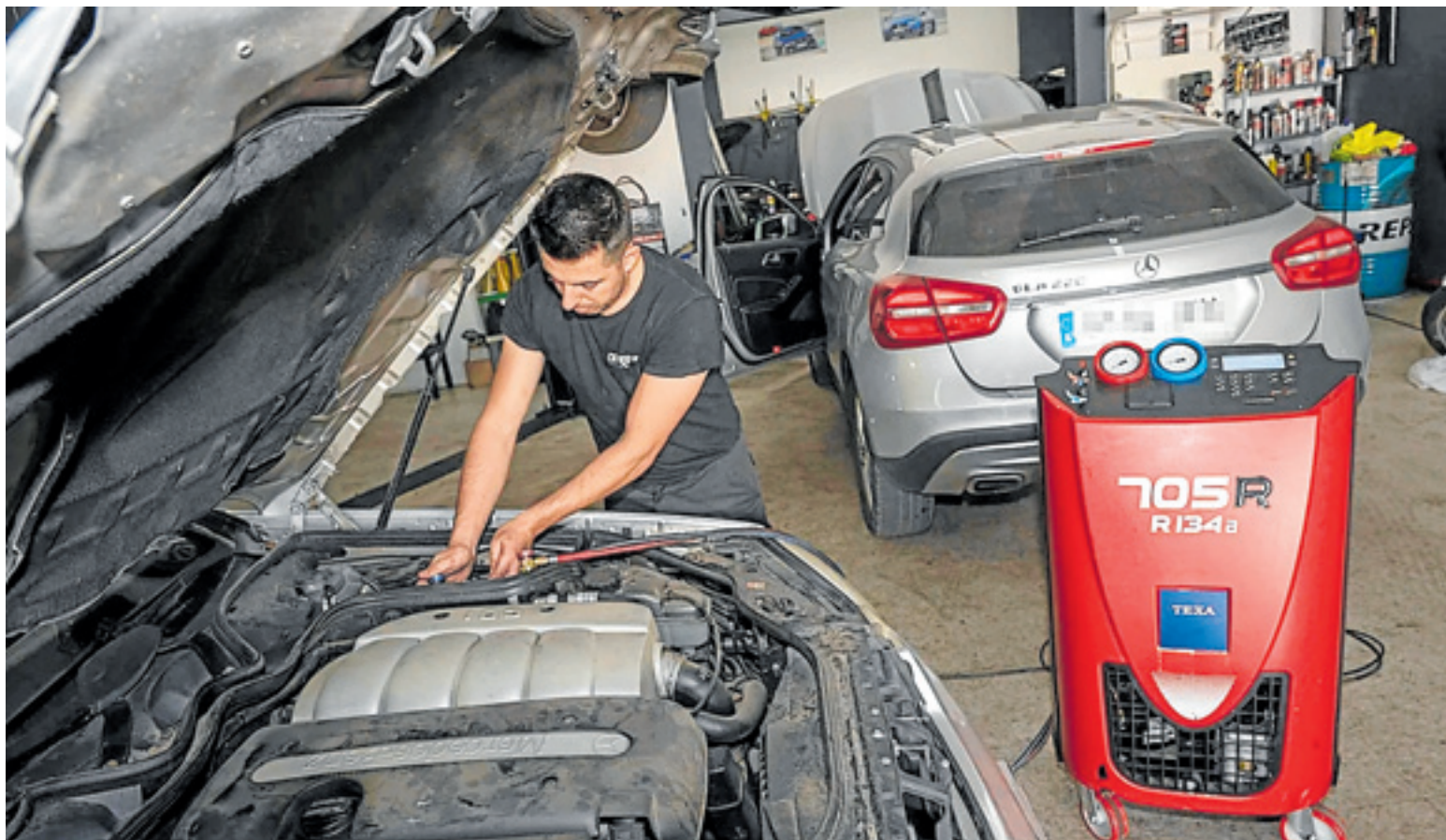
En Talleres GRIP, en la barriada de La Estación de Badajoz, hacen una recarga de aire acondicionado. JOSÉ VICENTE ARNELAS
