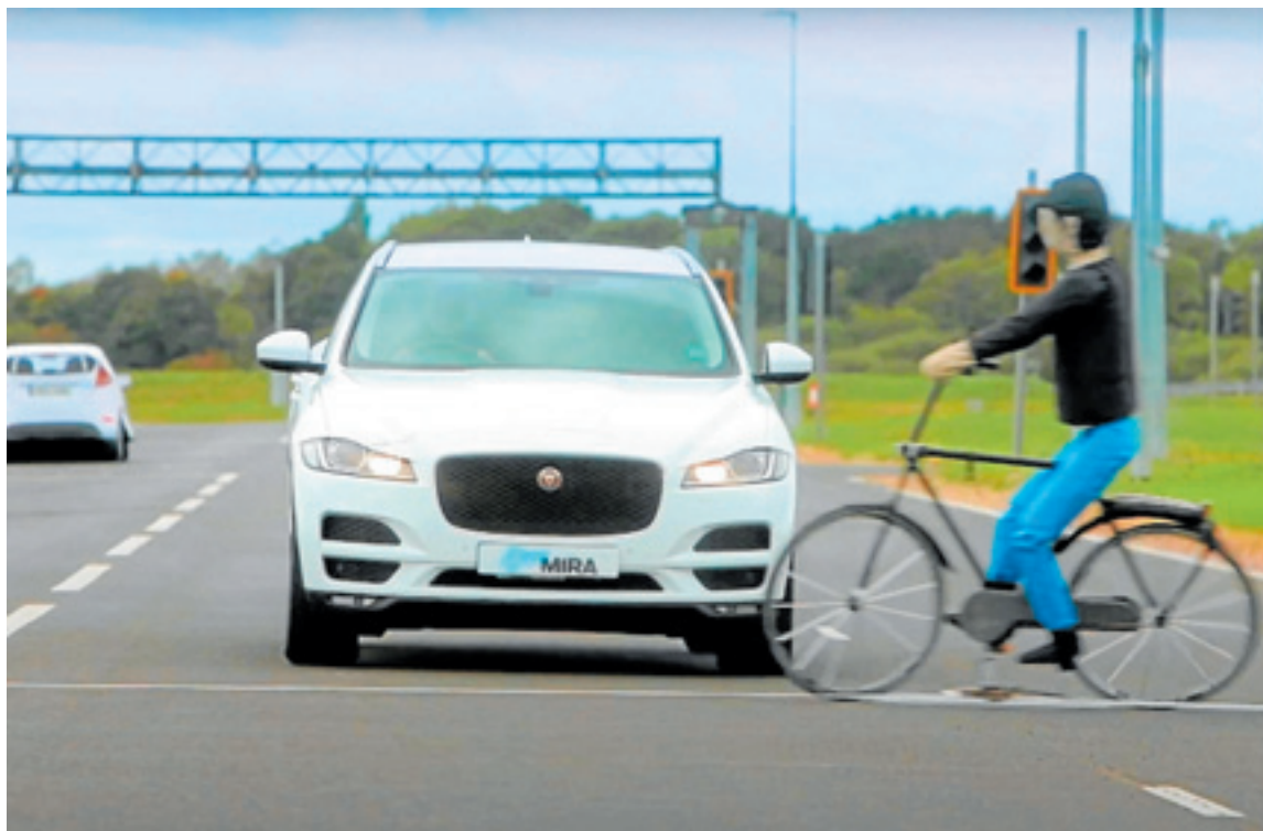
Un turismo en un ensayo de frenada automática por AEBS ante la irrupción inopinada del ciclista. POLO
